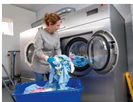
Foto 1: Viel Platz in der Trommel: Eine Waschmaschine für 35 Kilogramm Füllgewicht bietet Platz für bis zu 1'100 Wischtücher à 16 Gramm. (Foto: Miele)
