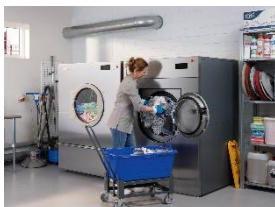
Foto 2: Auch mehr als 200 Mopps werden pro Waschgang sauber – mit dem patentierten Miele-Vorentwässerungsverfahren, das vor Beginn des Waschprozesses groben Schmutz und verunreinigtes Wasser aus den Mopps schleudert, sodass während der Hauptwäsche mehr Frischwasser einströmt. (Foto: Miele)
