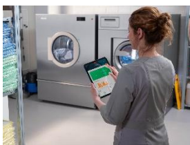
Foto 3: Die neuen Waschmaschinen sind für die Vernetzung mit dem digitalen Portal „Miele MOVE Connect“ vorbereitet. Hier kann geschultes Personal unter anderem die Betriebsdaten einsehen – beispielsweise den Wasser- und Energieverbrauch. (Foto: Miele)
